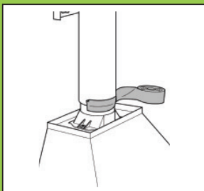
Paso 9: Coloca la manguera del conducto. Asegúrate de sellar todo con cinta adhesiva metálica para conductos.
