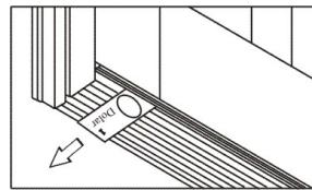
Su puerta tiene cubiertas para umbral ajustables. Cuando se ajustan correctamente, deben quedar apretadas y debe ser ligeramente difícil jalar un billete de un dólar por debajo de la puerta y de las vidrieras laterales cuando están bien cerradas. Se debe poder retirar el billete de un dólar sin rasgarlo.
