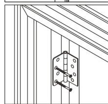
Con las vidrieras laterales abiertas, taladre orificios guía de 0,32 cm de diámetro e instale los tornillos para bisagra largos en las ubicaciones de las bisagras más cercanas al empaque. Realice el mismo procedimiento con todas las bisagras.
