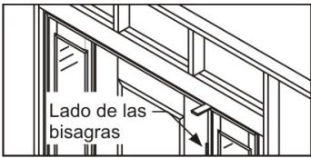
Coloque calzas sobre la viga vertical frontal de lado de las bisagras. Con un nivel de 6 pies, vuelva a revisar la viga vertical frontal para asegurarse de que está nivelada y recta. Termine de apretar el tornillo.
