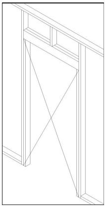
Las paredes que enmarcan el perímetro de la abertura deben estar en el mismo plano. Reviselo realizando una prueba con un cordel.
