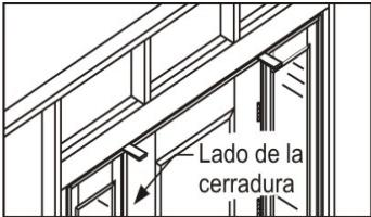
Coloque calzas sobre las vigas verticales del lado de la cerradura. Vuelva a revisar que el empaque siga teniendo un contacto parejo con el marco de la puerta. Termine de apretar el tornillo.
