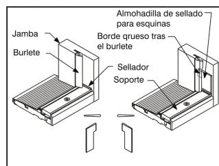
Aplique sellador (sellador híbrido de polímero, elastómero o poliuretano de alta calidad; Therma-Tru recomienda OSI QUAD MAX.) en la unión entre la cubierta de umbral ajustable y el marco de la puerta.
