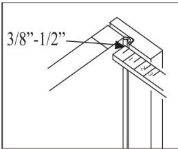
Ajuste la viga vertical central del lado de la cerradura de manera que el empaque haga contacto con el marco de la puerta de forma pareja en la parte de arriba, en medio y abajo. Debe haber un claro de 0,95 a 1,27 cm cuando la puerta esté completamente cerrada. Pre-taladrar e insertar un tornillo a través del marco en el cabezal, a cada lado del poste de Mull de la cerradura
