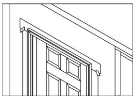
Aplique cinta autoadhesiva flexible para proteger superficies en la parte superior, esto evitará que el agua entre al inmueble o que haya daños. Coloque la cinta adhesiva en la parte superior de la lengüeta de la barrera resistente al agua (WRB).
