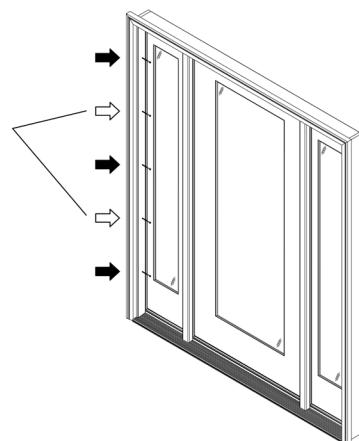
Cuña por encima de los tornillos entre la abertura y la jamba, y realice ajustes de manera que el margen entre la vidriera lateral y el entrepaño sea uniforme desde la parte superior a la parte inferior. Este margen debe ser ligeramente más grande que el margen de la puerta. Vuelva a revisar el marco de las bisagras de la vidriera lateral para asegurarse de que el empaque haga contacto de manera uniforme desde la parte superior a la parte inferior. Termine de apretar los tornillos.
