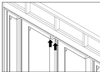
Cuando instale una puerta de estilo francés con vidrieras laterales activas, coloque cuñas temporales sobre el centro del bastidor delantero superior, entre los tornillos de la placa de ataque.
