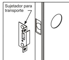
Retire los sujetadores para transporte. Verifique que la puerta y las vidrieras laterales funcionen correctamente.
