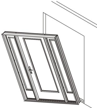
Levante la unidad. Con el borde superior inclinado, alejelo de la abertura, centre la unidad y coloque el borde inferior de la puerta en la solera inferior o en los cordones de masilla de calafateo, luego inclínelo hacia la abertura.
