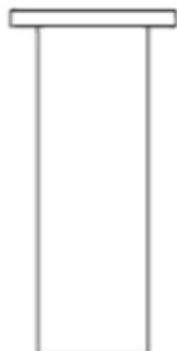
Douille d'axe de roue Qté : 2
