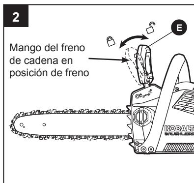
Asegúrese de que el freno de cadena esté funcionando correctamente antes de utilizar la motosierra. El mango del freno de cadena debe moverse hacia delante y hacia atrás con facilidad.
