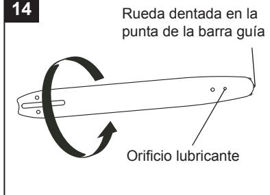
Además, la barra guía tiene una rueda dentada en su punta. La rueda dentada debe lubricarse semanalmente con una jeringa de grasa para prolongar la vida útil de la barra guía. Utilice una jeringa de grasa para lubricar semanalmente con aceite de cadena por medio del orificio lubricante (Fig. 14a). Gire la barra guía y compruebe que los orificios de lubricación y la ranura de la cadena estén libres de impurezas.
