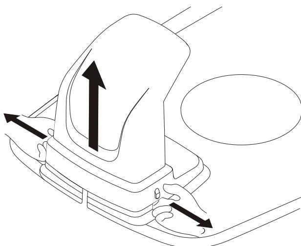
Retirez le couvercle de protection de la station de recharge en appuyant sur les languettes de chaque côté de la base et en soulevant le couvercle.
