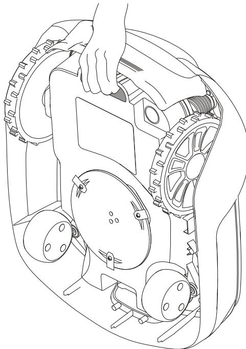
Appuyez sur le bouton **STOP** et retirez la clé de sécurité avant de la soulever.
