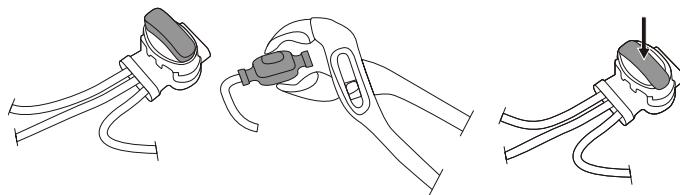
Insérez les deux extrémités du câble de périmètre ainsi que l'extrémité du câble guide dans le connecteur de l'épissure et du câble guide. Vérifiez que les câbles sont entièrement insérés dans le connecteur de l'épissure et du câble guide de sorte que les extrémités soient visibles à travers le connecteur de l'épissure et du câble guide.
