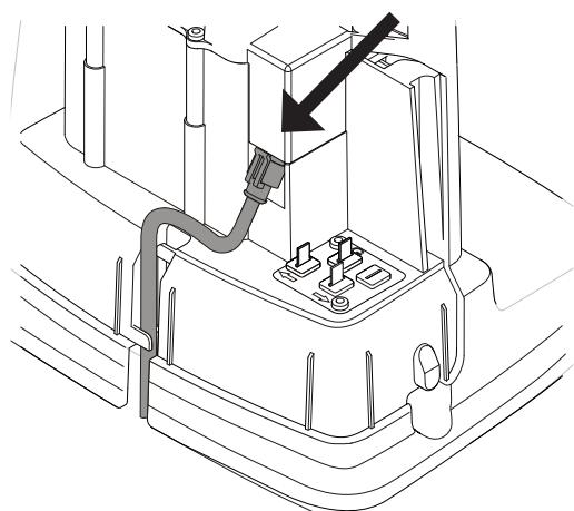
Connectez le câble basse tension à la station de recharge.
