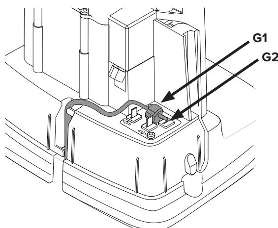
Inserte ambos extremos del cable delimitador, así como el extremo del cable de guía en el conector de empalme y de cable de guía. Compruebe que los cables estén totalmente insertados en el conector de empalme y de cable de guía de manera que los extremos sean visibles a través del conector de empalme y de cable de guía.
