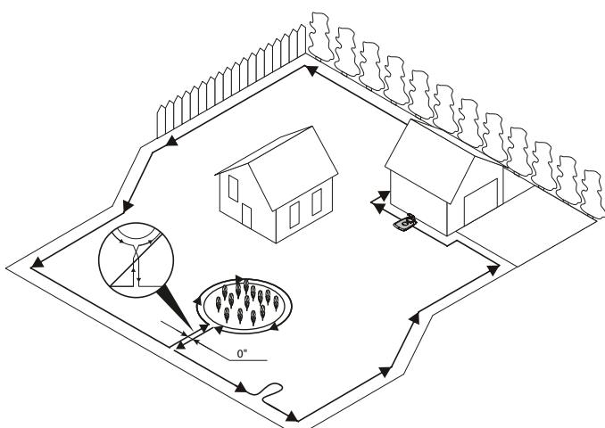
Fixez temporairement l'extrémité de la boucle de câble à un piquet ou à un autre objet de la station de recharge.
