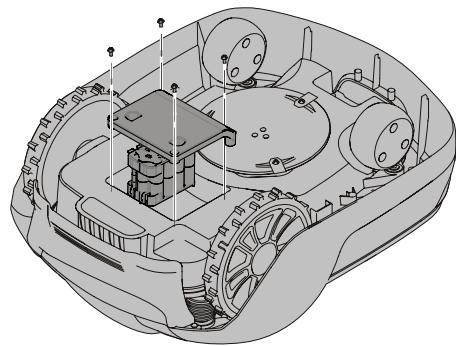
**AVERTISSEMENT!** Appuyez sur le bouton STOP et retirez la clé de sécurité avant de remplacer les batteries et portez des gants de protection.
