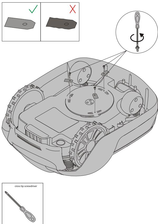
**AVERTISSEMENT!** Appuyez sur le bouton STOP et retirez la clé de sécurité avant de remplacer les lames et portez des gants de protection.
