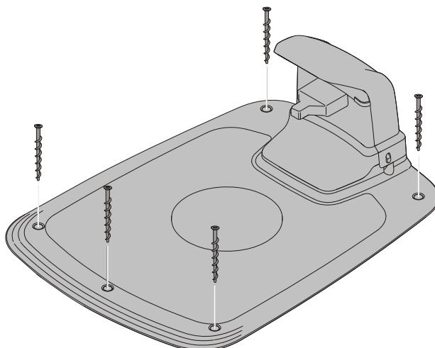
Fixez la station de recharge au sol à l'aide des cinq vis de fixation fournies en utilisant une clé hexagonale de 6 mm.
