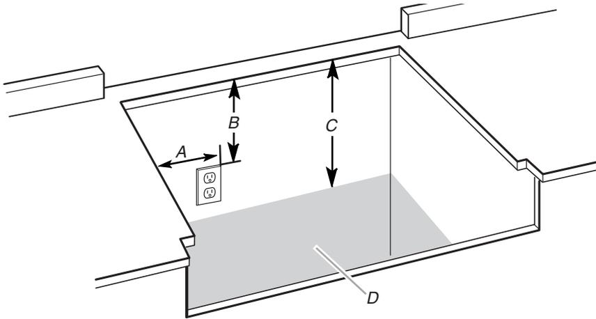
A. La prise de courant à 3 alvéoles reliée à la terre doit se trouver du côté gauche de l'ouverture découpée, à 16" (40,6 cm) max. de la paroi latérale de l'encastrement
