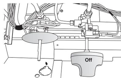
10. À l'aide d'un allumeur à butane avec extension, tourner le bouton de commande à LO (basse) et allumer le brûleur.
