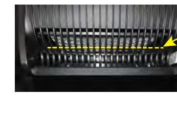
Use the bracket inside the chassis to line up with the wick./ Utiliser le support à l'intérieur du châssis pour se aligner avec la mèche./ Utilice el soporte dentro del chasis para alinearse con la mecha.
