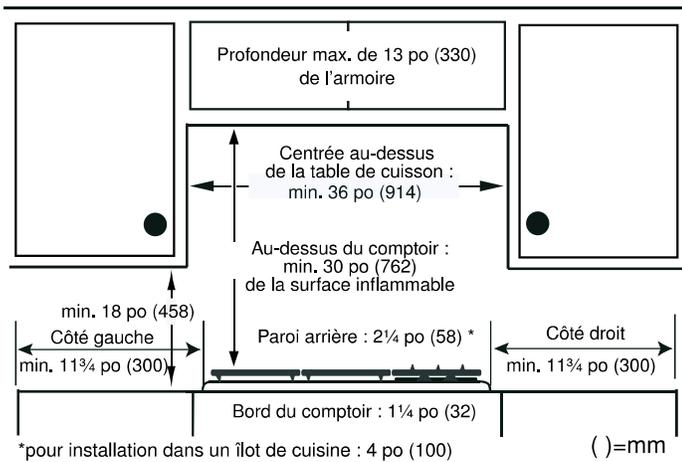
Pour une installation dans un îlot de cuisine, il faut maintenir une distance minimum de 4 po (100 mm) entre la table de cuisson et le bord du plan de travail.
