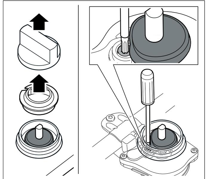
3. Consulter le tableau suivant pour connaître le réglage des vis de réglage (M) des robinets de gaz :
