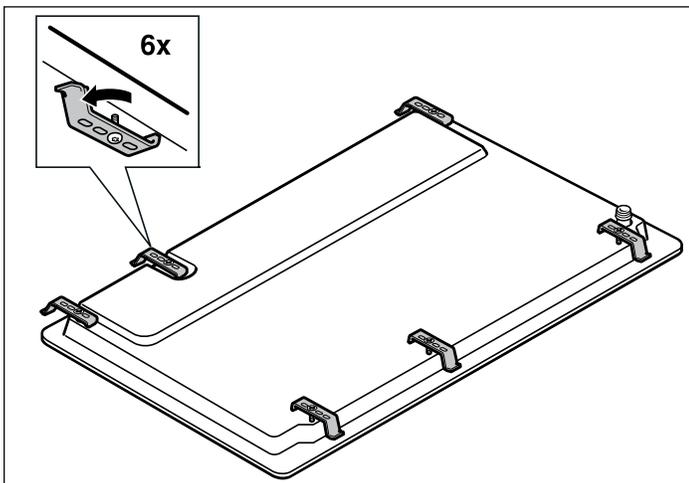
3. Tourner les équerres de fixation et les visser complètement. L'orientation des équerres de fixation dépend de l'épaisseur de la surface du plan de travail. Pour les plans de travail entre 2 po (50 mm) et 2¾ po (70 mm) d'épaisseur, insérer un bloc de bois entre l'extrémité de la vis de réglage et le dessous du plan de travail.
