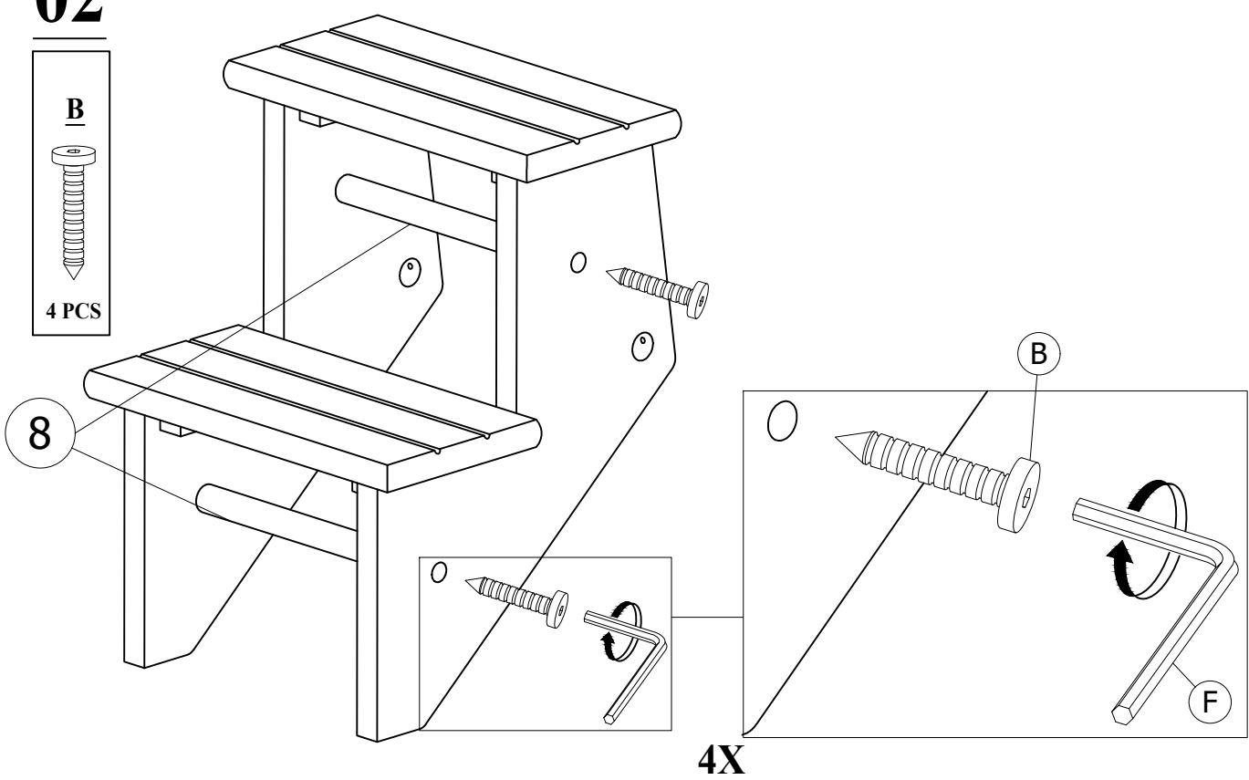
TIGHTEN SCREW COMPLETELY.
