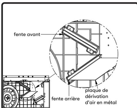
1. Retirez les filtres déflecteurs. Retirez les couvercles des fentes de la plaque de dérivation d'air. Retirez la plaque de dérivation d'air métallique de la fente avant et repositionnez-la dans la fente arrière. Réinstallez les couvercles des plaques de dérivation d'air.
