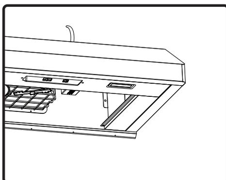
3. Retirez toute la mousse noire de l'ouverture du filtre avant d'installer les supports de filtre à charbon.
