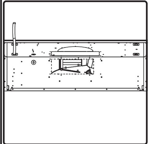
1. À l'aide d'un tournevis à tête plate, retirez la plaque à défoncer rectangulaire située à l'arrière du capot.
