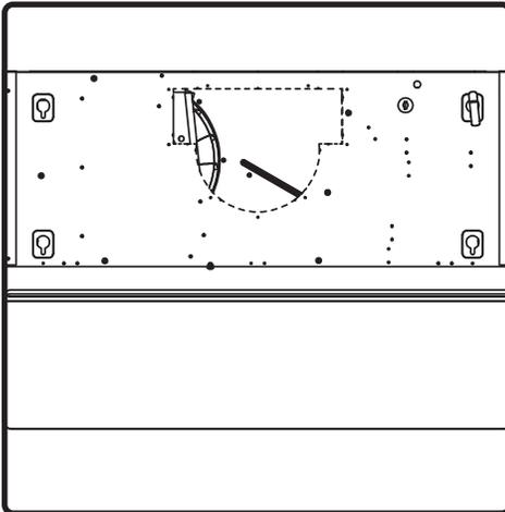
1. À l'aide d'un tournevis à tête plate, retirez les plaques à défoncer rectangulaire et ronde situées sur le dessus du capot.
