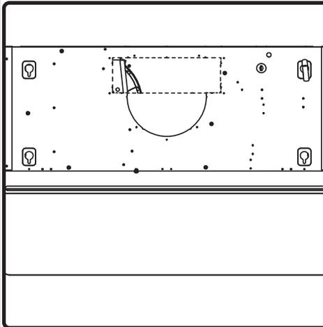
1. À l'aide d'un tournevis à tête plate, retirez uniquement la section rectangulaire de la plaque à défoncer située sur le dessus du capot.
