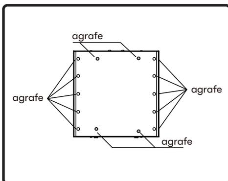
2. En utilisant des composants de ZRC-0071, placez (2) un filtre à charbon à l'arrière des filtres déflecteurs. Fixez les filtres à charbon en place avec des clips en caoutchouc.
