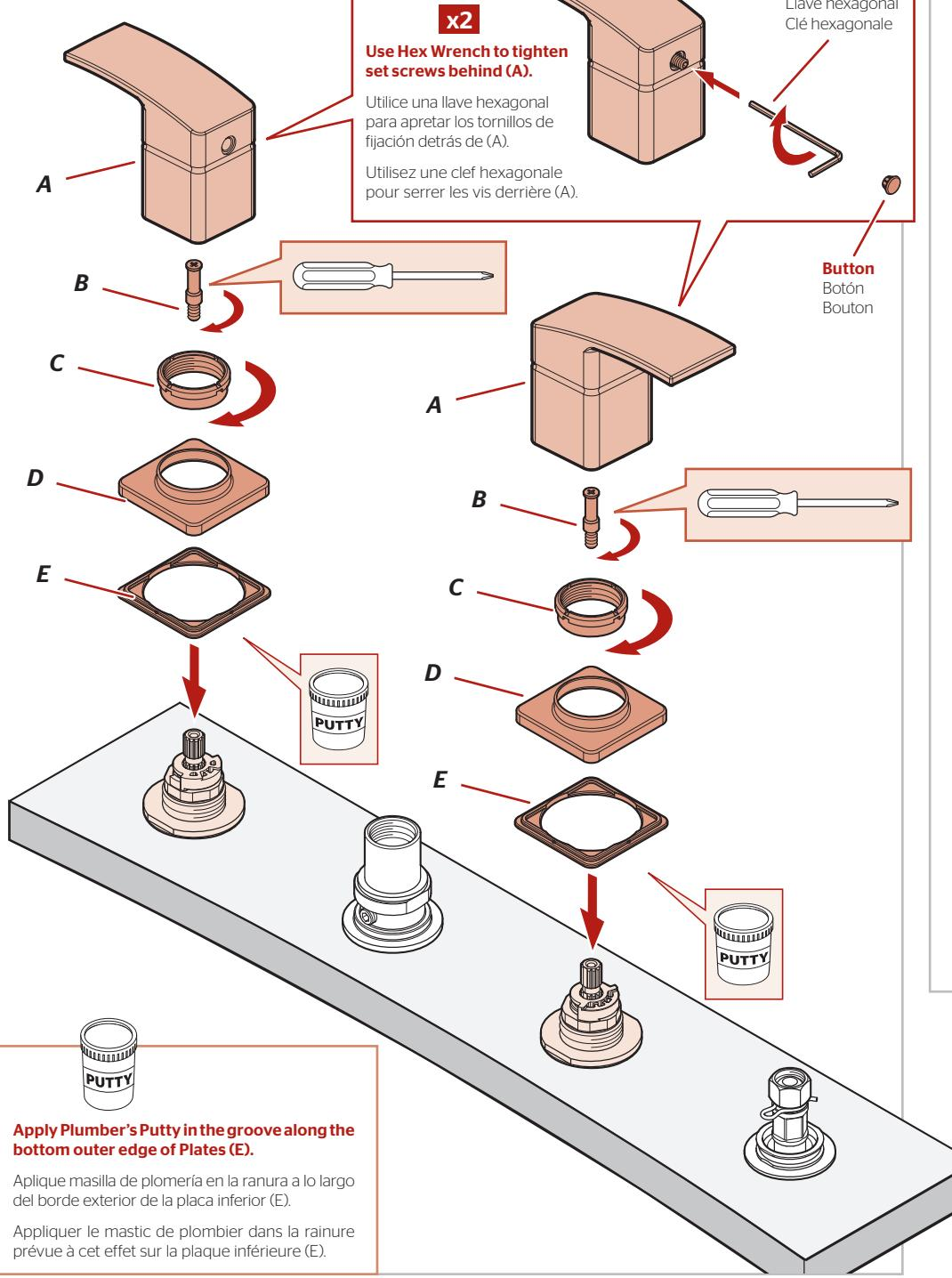
**3B Diverter Installation****Instalación de la manija y el desviador****Installez la poignée et le mitigeur**
