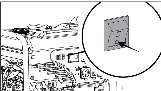
4. Si el generador fue encendido de forma eléctrica, oprima el interruptor de la batería a la posición "APAGADO."
