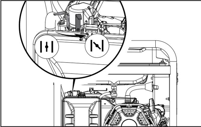
4. Jale la cuerda de arranque lentamente hasta sentir resistencia, luego jale rápidamente.
