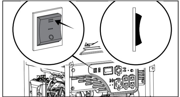
2. Oprima el interruptor de la batería a la posición "ENCENDIDO".
