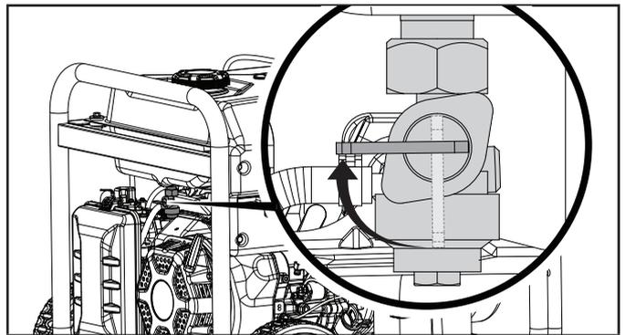
**Importante:** Siempre asegúrese de que la válvula de combustible, interruptor de arranque, y el interruptor de la batería estén siempre en posición "APAGADO" cuando el generador no será utilizado por un periodo extendido.
