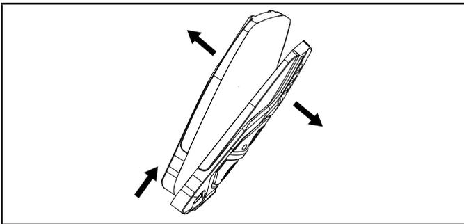
5. Retire con cuidado la placa de circuito para localizar y reemplazar la batería CR2016.
