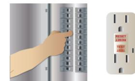
B. Si la bomba no arranca, verifique el GFCI o el interruptor del panel de disyuntores para ver si está en pleno funcionamiento.
