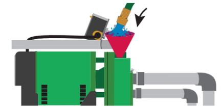
C. Si la bomba funciona todo el tiempo, asegúrese de que la bomba haya sido cebada correctamente. Si la bomba no está reteniendo el cebado, inspeccione la válvula de retención, la válvula de zapata y la tubería, luego vuelva a cebar.
