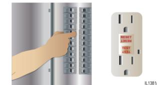
B. Si la bomba no arranca, verifique el GFCI o el interruptor del panel de disyuntores para ver si está en pleno funcionamiento.
