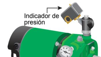
D. Si la bomba funciona pero no se apaga, revise el presostato.
