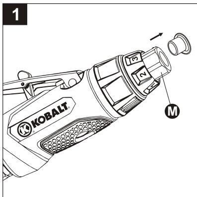
2. Fixez manuellement le connecteur mâle (E) dans l'entrée d'air (M) (Consultez la figure 2).
