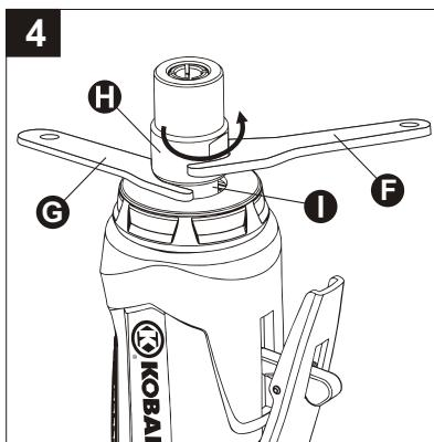
5. Insérez une meule de 1/4 po (C) dans le trou du mandrin (J). Serrez la chemise du mandrin (H) dans le sens des aiguilles d'une montre à l'aide de la grande clé (F) tout en tenant la petite clé (G) sur les facettes du porte-mandrin (I). Assurez-vous que la meule de 1/4 po (C) est bien installée et serrée (Consultez la figure 5).
