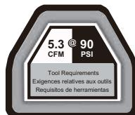
**IMPORTANT :** Cet outil nécessite un débit d'air d'au moins 5,3 pi<sup>3</sup> par minute à une pression de 90 lb/psi<sup>2</sup>. Vérifiez les spécifications de votre compresseur d'air afin de vous assurer qu'il satisfait aux exigencies minimales (pi<sup>3</sup>/min et lb/psi<sup>2</sup>). L'utilisation d'un tuyau à air peut entraîner une chute de pression de jusqu'à 15 lb/psi<sup>2</sup>. Il peut donc s'avérer nécessaire d'augmenter la pression afin de maintenir un niveau adéquat.
