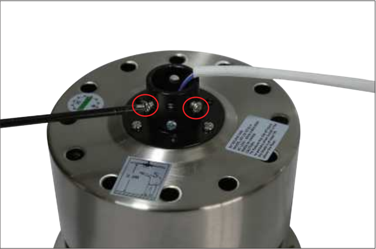
Paso 4 Afloja los dos tornillos del acoplador.
