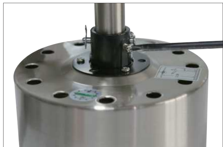
Paso 8 Aprieta los dos tornillos del acoplador.
