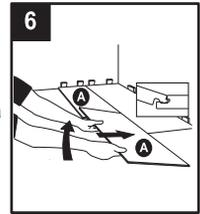
7. Cuando finaliza la alineación, empuje con cuidado la segunda plancha (A) de la segunda fila hacia abajo hasta que la lengüeta se asegure en la ranura de la primera plancha (A) de la segunda fila. **Nota:** para completar el empalme, será necesario dar unos golpes suaves con un bloque (no se incluye).
