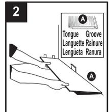
3. Alinee la siguiente plancha (A) sobre el extremo de la primera plancha (A) de manera que la unión en la primera plancha (A) quede apretada cuando la segunda plancha (A) esté plana.
