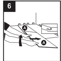
7. Une fois les extrémités alignées, poussez doucement la deuxième planche (A) de la deuxième rangée vers le bas, jusqu'à ce que la languette s'emboîte dans la rainure de la première planche (A) de la deuxième rangée. **Remarque :** Il sera peut-être nécessaire de taper légèrement sur la planche à l'aide d'un bloc de battage (non inclus) pour que la languette s'emboîte complètement.
