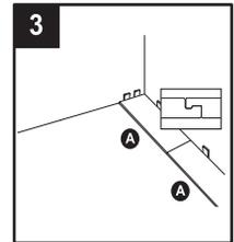
4. Continúe de esta manera hasta completar la primera fila. Corte la última plancha (A) al largo adecuado, dejando una zona de expansión de 12,7 mm. Coloque cuñas según sea necesario.
