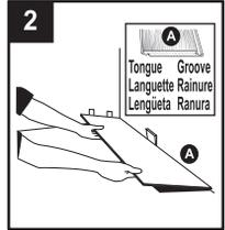
3. Alignez la planche (A) suivante par-dessus l'extrémité de la première planche (A) afin que le joint de la première planche (A) soit serré correctement lorsque la deuxième planche (A) est à plat. **Remarque :** Il peut être nécessaire d'ajuster les planches (A) afin que celles-ci soient fixées solidement.
