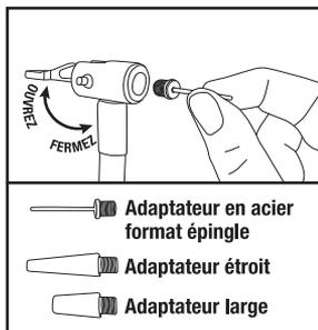
Basculez le levier du Connecteur Rapide en position ouverte. Glissez l'accessoire choisi dans le connecteur. Abaissez le levier pour verrouiller.
