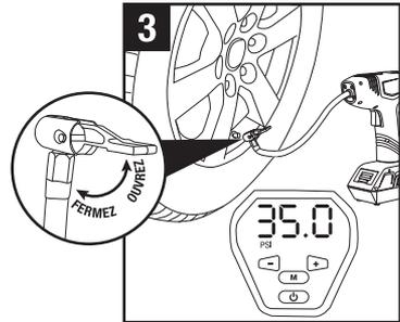
3 Basculez le levier du Connecteur Rapide en position ouverte et attachez à la tige de valve. Abaissez le levier pour verrouiller. L'affichage affichera la pression du pneu courante.
