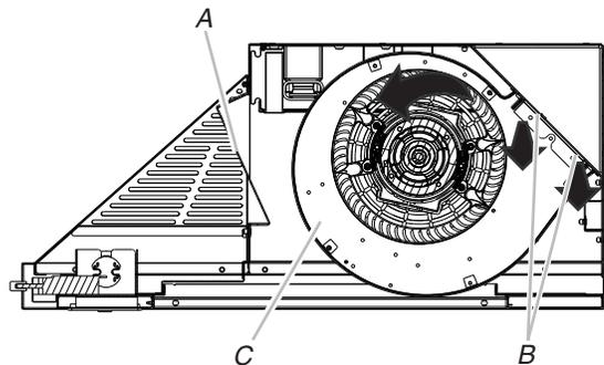
A. Opercule arrachable de la plaque de montage avant
