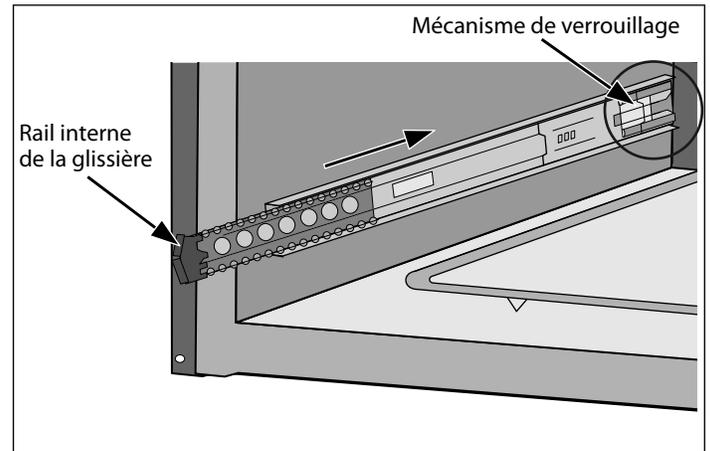
**Remarque :** Une force modérée exercée sur le mécanisme de verrouillage du porteur à roulement à billes noir en plastique est requise pour placer la glissière dans la position de verrouillage du tiroir. Le tiroir est verrouillé lorsqu'il demeure en place et ne revient pas automatiquement en position ouverte.
