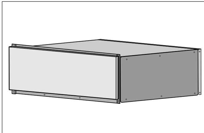
4. Vérifiez le fonctionnement du tiroir PPO en poussant sur le centre de la portion inférieure de l'avant du tiroir (l'endroit optimal pour la fonction).
