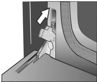
5. Poussez les leviers sur les deux charnières vers le haut jusqu'à ce qu'ils soient bloqués dans le logement en affleurement de la partie avant du bâti du four.
