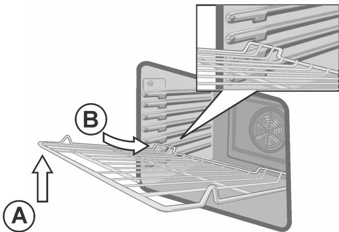
3. Incliner la grille vers le haut (A) pour permettre à la partie arrière ascendante inclinée de la grille de glisser sous la butée moulée dans la partie avant du guide de grille comme illustré ci-dessus.
