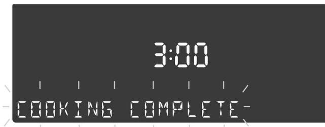
Cet écran reste dans l'affichage jusqu'à ce qu'on l'efface en appuyant sur la touche à effleurement **Oven Clear/Off** (Four Effacer/Désactiver) ou jusqu'à ce que la sonde soit retirée. Ensuite, l'écran repasse en mode Veille.
