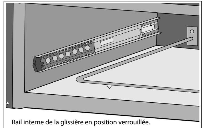
2. Placez l'assemblage du tiroir devant l'assemblage du compartiment et alignez le rail (bout en plastique du rail) avec l'assemblage du porteur à roulement à billes. Tout en gardant l'assemblage du tiroir droit et au niveau par rapport au compartiment, insérez doucement le tiroir dans l'assemblage du compartiment.
