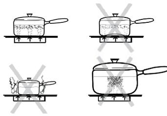
**Diamètres équivalents** – Le fond d'une casserole doit recouvrir ou être équivalent au diamètre de l'élément utilisé. Les ustensiles peuvent dépasser de l'élément de 1 po (2,5 cm) sur le pourtour de celui-ci.
