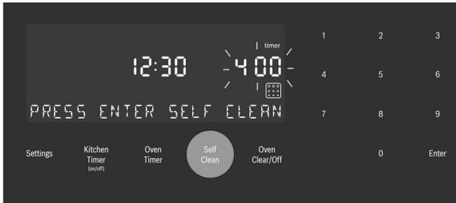
4. Lorsque la durée d'autonettoyage désirée est affichée, appuyer sur **Enter**.
