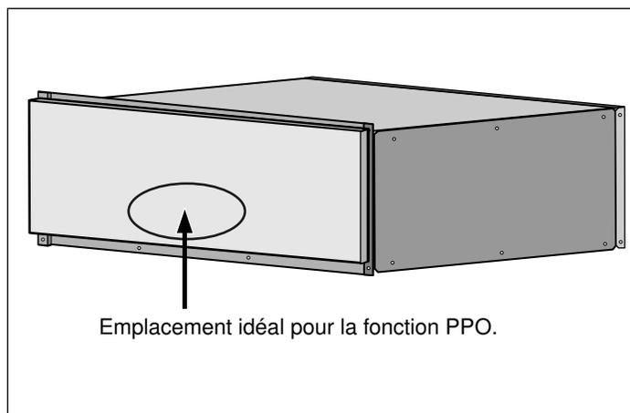
**Remarque :** Il est à noter que l'endroit optimal recommandé pour l'ouverture du tiroir est la portion inférieure de l'avant du tiroir. Le tiroir fonctionne lorsqu'une pression est appliquée à n'importe quel endroit sur l'avant du tiroir, mais une pression accrue pourrait être nécessaire pour activer le mécanisme d'ouverture à certains endroits.
