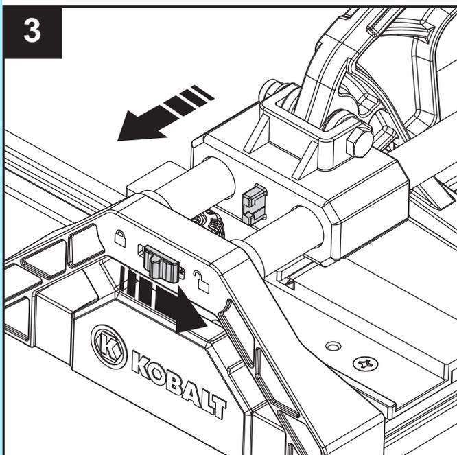
3. Hay un seguro en el soporte frontal (retire el seguro para liberar el mango antes de empezar a usarlo), el cual enganchará el mango durante el movimiento del cortador de baldosas para evitar cualquier deslizamiento o impacto.
