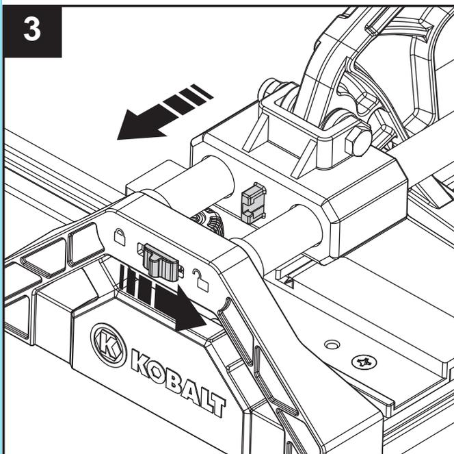
3. Un dispositif de verrouillage est situé sur la pièce de soutien avant (déverrouillez-le pour dégager le levier avant de commencer à utiliser l'outil). Il permet de retenir le levier pendant le fonctionnement du coupe-carreaux afin d'éviter tout glissement ou choc.
