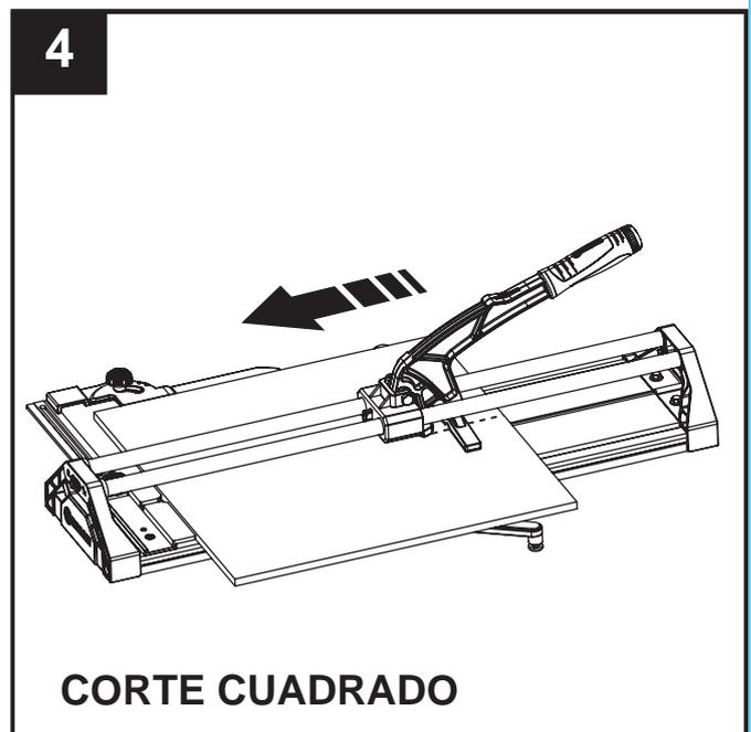
4. Marque la baldosa para cortarla al ancho adecuado. Coloque la baldosa a 90° y con suficiente presión marque la baldosa una vez desde el borde posterior hasta el borde frontal.
