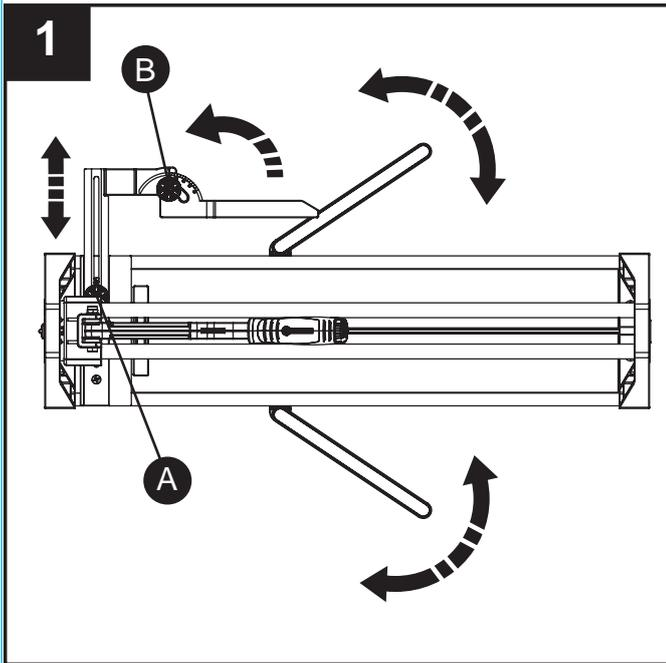
1. Coloque los brazos de extensión, la regla lateral (perilla de liberación A) y la guía de ángulo (perilla de liberación B) como lo desee para obtener un posicionamiento estable de la baldosa (no se incluye) para marcar.
