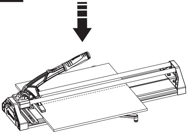
5. Alinee la barra rompedora con el borde frontal de la baldosa y presione el mango.
