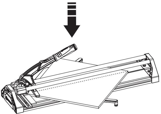
7. Alinee la barra rompedora con la esquina de la baldosa y presione el mango.
