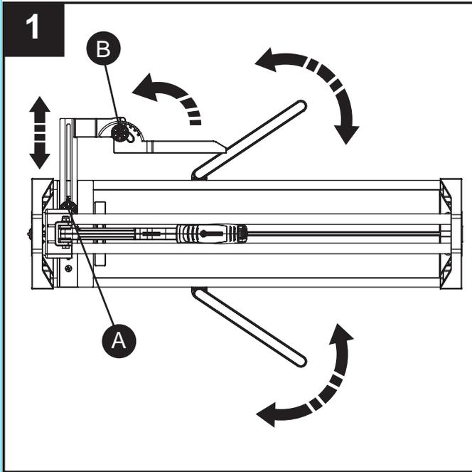
1. Placez les bras d'extension, la règle latérale (bouton de déverrouillage A) et le guide d'angle (bouton de déverrouillage B) selon vos besoins de sorte que le carreau (non inclus) soit dans une position stable au moment d'être rayé.
