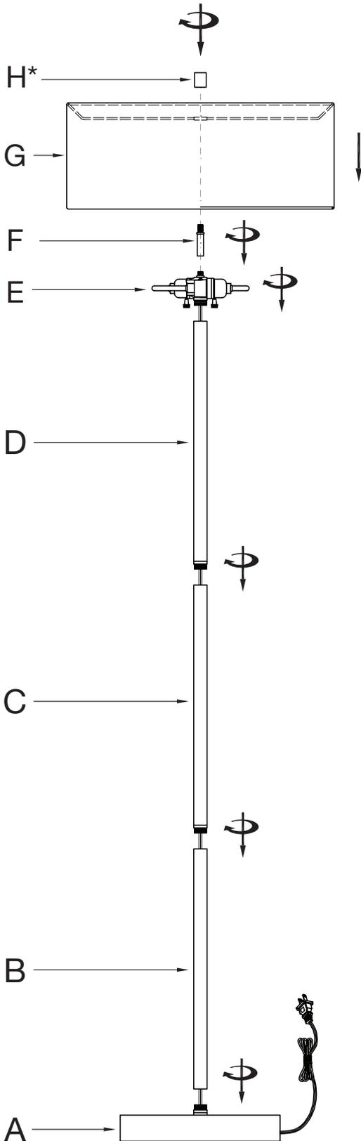
**\* La parte H (Terminación superior) puede venir preinstalada a la parte F (Soporte de pantalla). Desatornille la parte H antes de instalar la parte G (Pantalla), luego vuelva a instalar la parte H para asegurar.**
