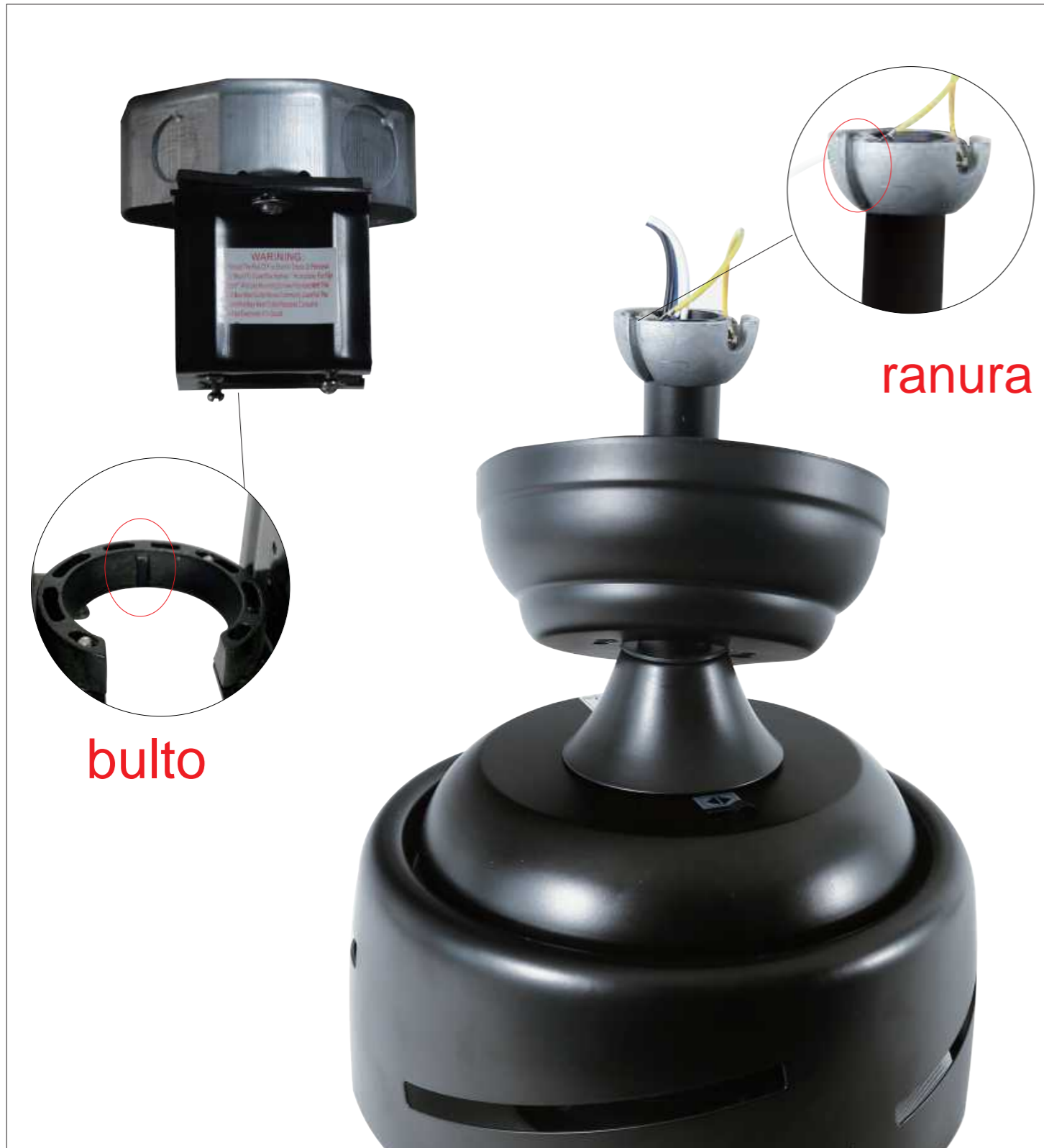
Paso 10 Cuelgue el ventilador en el soporte de suspensión y alinee la ranura de la varilla inferior con la protuberancia del soporte de suspensión.
