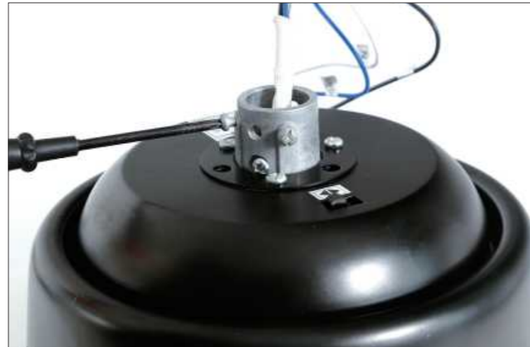
Paso 5 Afloje los 2 tornillos del enganche.
