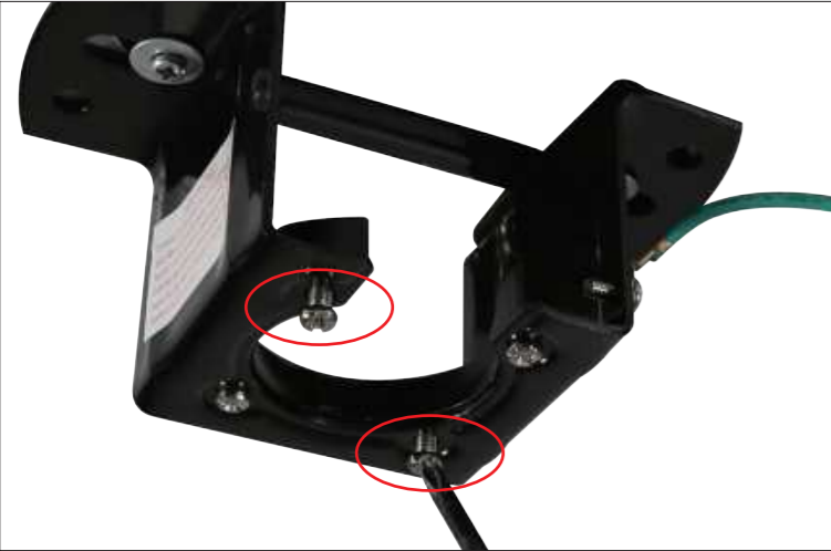
Paso 2 Afloje los dos tornillos opuestos.
