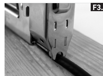
Place staple gun wire guide over the cable. Coloque la guía de alambre de la pistola de grapas sobre el cable.
