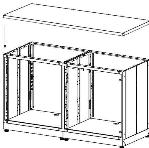
plate pour guider la mise en place d'un des côtés du comptoir depuis l'intérieur, ou devoir utiliser un maillet en caoutchouc pour taper doucement de l'intérieur afin que le dessus soit bien à plat sur le caisson de l'armoire. Retirez toute pellicule protectrice restante du comptoir. N'utilisez pas de couteau ou d'objet tranchant pour enlever la pellicule. Si vous commencez par un bord latéral et tirez lentement, la pellicule protectrice se libérera du comptoir.
