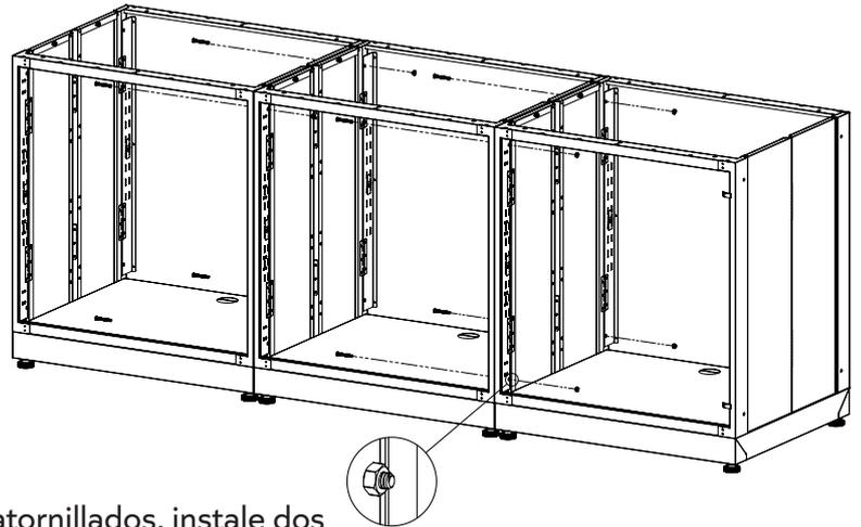
Una vez que sus armarios dobles o triples estén atornillados, instale dos soportes superiores (J) para el armado de su armario doble y cuatro soportes superiores (J) para el armado de su armario triple. Atornille el soporte superior (J) a la parte superior de cada panel lateral interior con dos tornillos (I) por soporte, tal como se muestra.
