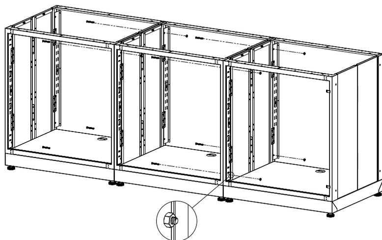
Une fois vos armoires doubles ou triples boulonnées, installez deux supports supérieurs (J) pour la configuration de votre armoire double et quatre supports supérieurs (J) pour la configuration de votre armoire triple. Boulonnez le support supérieur (J) à la partie supérieure de chaque panneau latéral intérieur avec deux boulons (I) par support comme le montre l'image.
