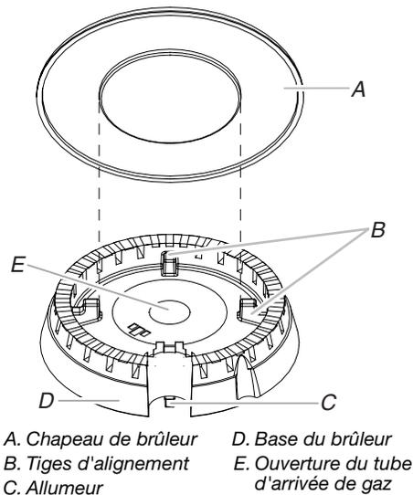
**Ouverture du tube d'arrivée de gaz :** Pour que le brûleur s'allume convenablement, il faut que le gaz puisse passer librement à travers l'orifice. Garder cette zone propre et ne pas laisser les produits renversés, les aliments, les agents de nettoyage ou tout autre produit pénétrer dans l'ouverture du tube d'arrivée de gaz. Protéger le tube d'arrivée de gaz contre les renversements en utilisant toujours un chapeau de brûleur.
