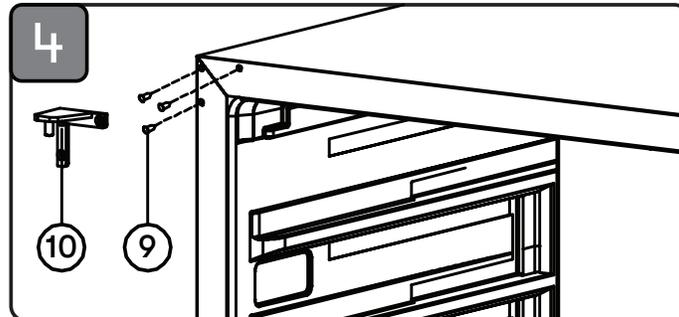
4. Retirez les 3 couvercles décoratifs noirs (8) en haut à gauche de l'armoire. Installez les couvercles décoratifs noirs en haut à droite de l'armoire et installez la nouvelle charnière supérieure (9) du paquet de matériel qui comprend le manuel d'installation en haut à gauche de l'armoire avec 3 vis.
