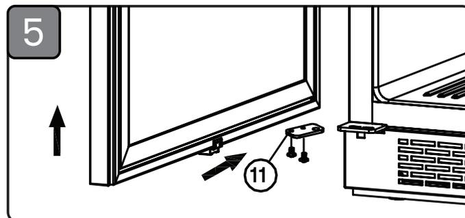
5. Installez l'axe de porte inférieur (10) et installez la porte une fois correctement alignée. Fixez la porte avec la vis supérieure sur le dessus de la charnière (4).
