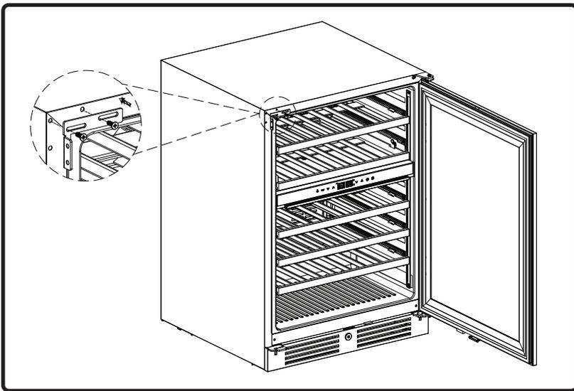
1. Ouvrez la porte et retirez les clous décoratifs noirs. Placez le support anti-basculement sur le refroidisseur et fixez-le avec (2) vis à tête plate M4\*12.
