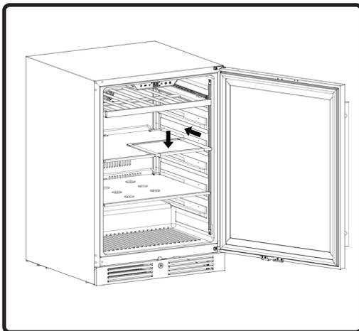
5. Installez soigneusement la tablette quart de verre rétractable dans la position souhaitée.
