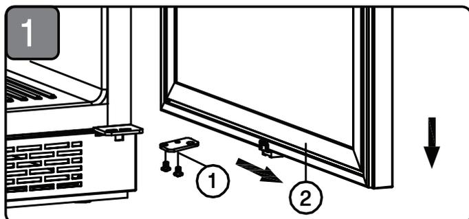
1. Retirez les 2 vis de l'axe inférieur de la porte (1) et retirez une vis supérieure sur le dessus de la charnière (4). Retirez ensuite la porte (2) et retirez la plaque d'axe (1) de la porte.
