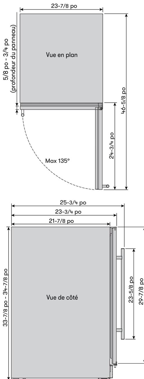
**REMARQUE:** La profondeur de l'armoire fournie comprend un panneau de recouvrement de 3/4 po.
