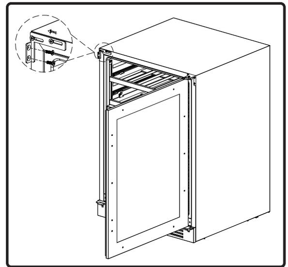
2. Poussez le refroidisseur à l'emplacement souhaité pour l'installation. Ouvrez la porte et installez le support anti-basculement sur l'armoire avec (2) vis autotaraudeuses ST4\*12.
