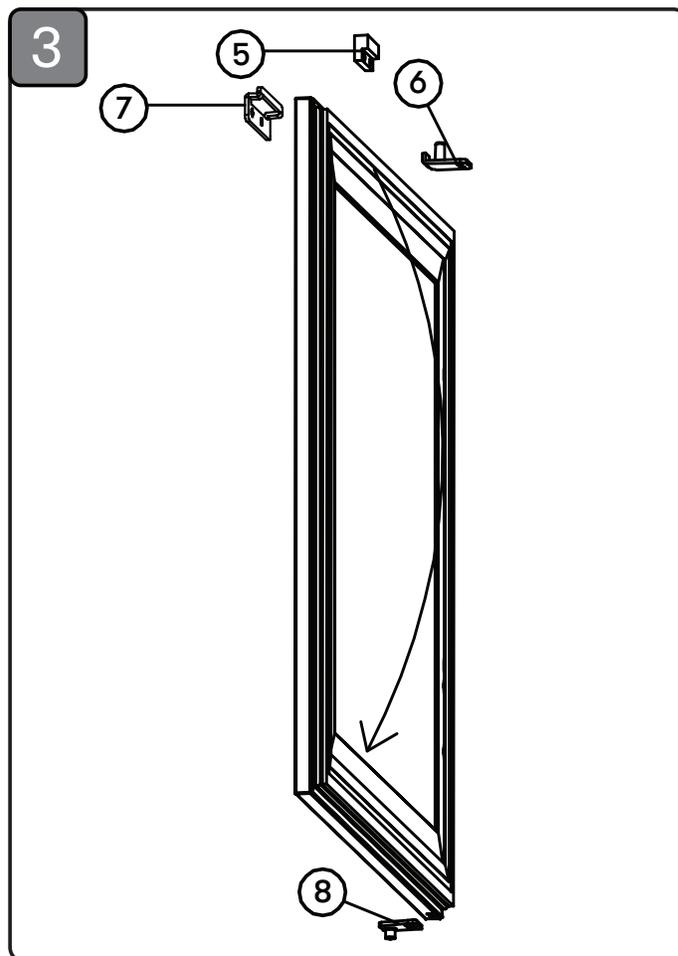
3. Retirez l'aimant de porte (5), la butée de porte (6) et le verrou de sécurité pour enfants (7) avec 2 vis chacun. Retirez les 2 vis de l'axe supérieur de la porte (8) monté sur le dessus de la porte et retirez-le. Ensuite, installez l'aimant de porte et le verrou de sécurité pour enfants sur le côté opposé du cadre de porte. Sortez le nouvel axe de porte supérieur et le butoir de porte du paquet de matériel et installez-les avec 2 vis. Faites pivoter la porte de 180 degrés.
