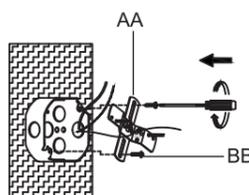
4. Dégarnir une longueur de 254 mm (3/4") d'isolant de l'extrémité des fils du luminaire. Réunir et entortiller les deux extrémités dégarnies à l'aide de pinces (non comprises : noir avec noir (alimentation), blanc avec blanc (neutre)). Couper les extrémités. Enrouler le fil de mise à la terre du boîtier de prises de courant autour de la vis verte préassemblée sur la traverse (AA); brancher ensuite le fil de mise à la terre du boîtier de prises de courant au fil de mise à la terre du luminaire.
