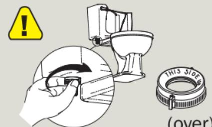
**1** a) Fermez l'alimentation en eau. Placez le seau. Actionnez la chasse d'eau. Enlevez l'eau restante à l'aide d'une éponge. b) Coupez l'alimentation en eau. Retirez l'écrou de montage. Utilisez une clé, au besoin. Conseil: l'eau sera dans la ligne d'alimentation. c) Retirez la vieille soupape.
