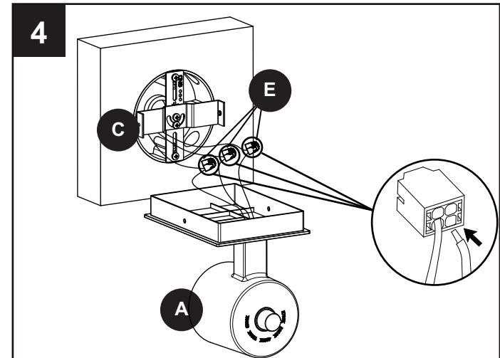
⚠ Connect fixture wires to the supply wires-black to black, white to white, and green to copper/bare./Raccordez les fils du luminaire aux fils d'alimentation électrique : le fil noir avec le fil noir, le fil blanc avec le fil blanc et le fil vert avec le fil en cuivre ou dénudé./Conecte los conductores de la lámpara a los conductores del suministro: negro con negro, blanco con blanco y verde a cobre/desnudo.
