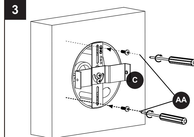
Attach the mounting bracket (A) to the junction box using the junction box screws (AA)./Fixez le support de fixation (A) à la boîte de jonction à l'aide des vis pour boîte de jonction (AA)./Fije el soporte de montaje (A) a la caja de conexiones con los tornillos de la caja de conexiones (AA).
