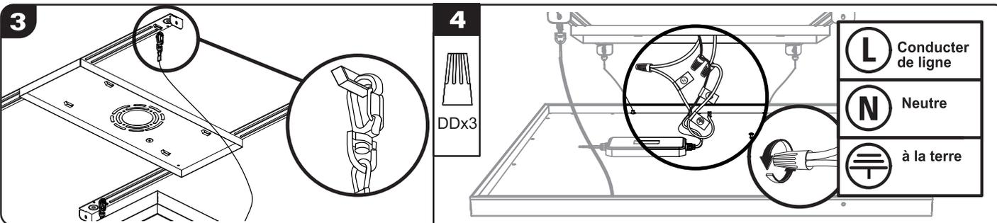
**3** Tenez le luminaire au niveau de la plaque de montage sécurisée et attachez les deux crochets de support des fils sortant de l'arrière du luminaire et le crochet de support des fils sortant de l'avant du luminaire dans les fentes conçues spécialement à cet effet dans la plaque de montage pour maintenir temporairement en place le luminaire en vue de son câblage.
