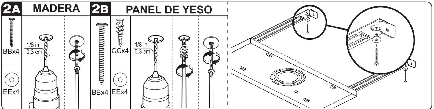
**2A** Localice los agujeros abiertos para el montaje en las esquinas de la placa de montaje y taladre un agujero piloto de 0,32 cm en el centro. Si se encuentra un montante de madera, utilice los tornillos para madera (BB) y las arandelas (EE) que se suministran para fijar la placa de montaje directamente al montante.
