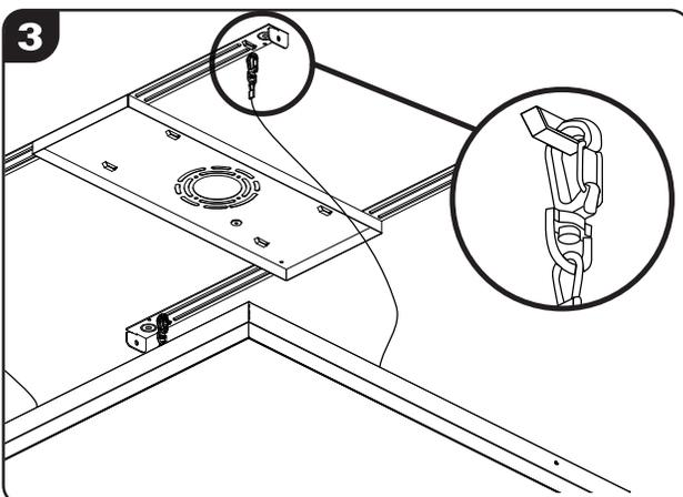
**3** Sujete hacia arriba el accesorio para iluminación, contra la placa de montaje fijada, e instale los dos ganchos de alambre de soporte del lado trasero y el gancho del lado delantero del accesorio para iluminación en las ranuras diseñadas especialmente en la placa de montaje para sujetar temporalmente el accesorio para iluminación con el fin de cablearlo.
