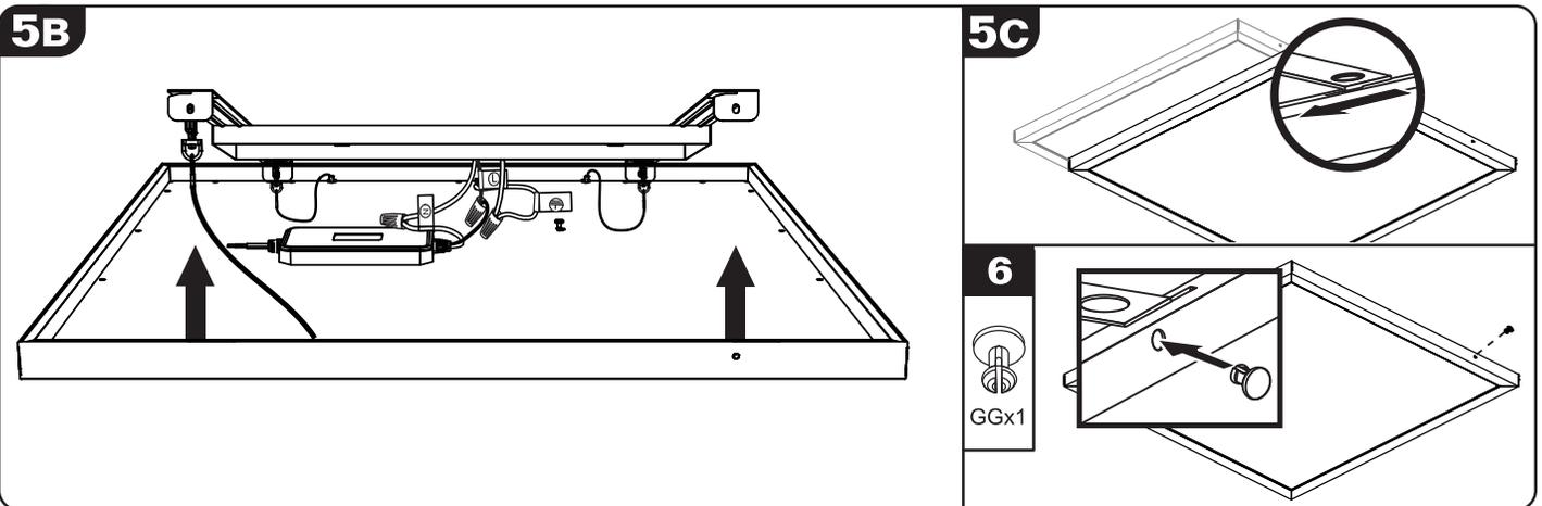
**5B** Mientras mantiene las 2 primeras lengüetas metálicas insertadas, gire el panel hacia arriba e inserte las 2 lengüetas restantes en el lado opuesto.
