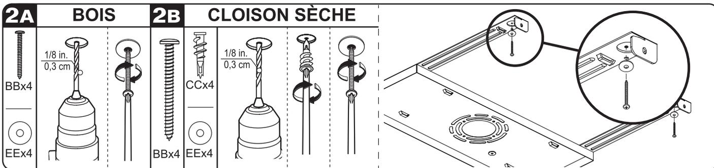
**2A** Localisez les orifices ouverts en vue du montage dans les coins de la plaque de montage et percez un trou pilote de 0,32 cm au centre. Si vous rencontrez un montant en bois, utilisez des vis à bois (BB) et les rondelles correspondantes (EE) fournies pour assujettir la plaque de montage directement sur le montant.
