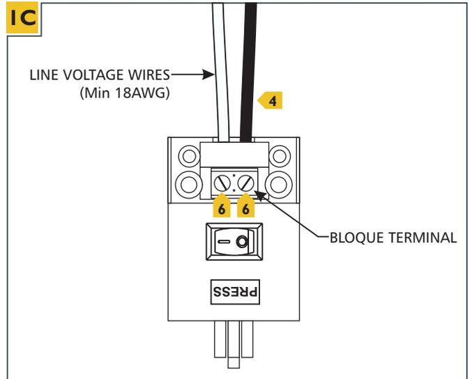
**Nota:** Este transformador no requiere conexión a un cable de tierra de alimentación para asegurar un funcionamiento seguro. Está fabricado con una carcasa polimérica que proporciona un aislamiento completo. Si el uso de tres cables de alimentación del conductor, por favor cortar el conductor de tierra limpia por lo que termina en el compartimiento de cableado del transformador.
