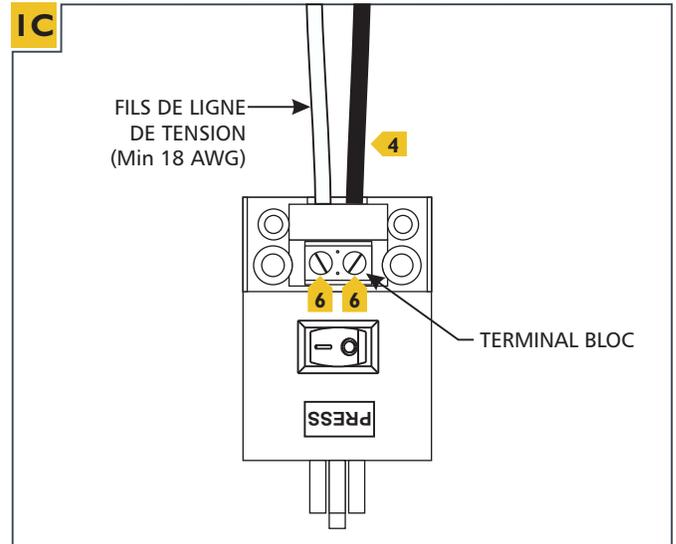
**Remarque:** Ce transformateur ne nécessite pas de connexion à un fil de terre de l'alimentation pour assurer un fonctionnement en toute sécurité. Il est fabriqué en utilisant un boîtier polymère qui offre une isolation complète. Si l'aide de trois fils conducteurs d'alimentation, s'il vous plaît couper le conducteur de terre proprement de sorte qu'il se termine dans le compartiment de câblage du transformateur.
