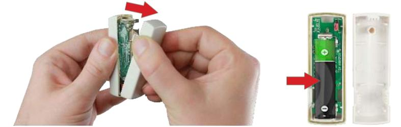
2. Utilice una moneda para abrir el Sensor de Movimiento e inserte una batería AA.
