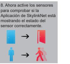
NOTE: Si se detecta movimiento, una luz LED roja en el interior del sensor parpadeará. El sensor no se activará por un nuevo movimiento a menos que no se haya detectado movimiento durante 15 segundos
