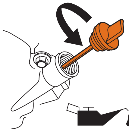
Figura 29 – Llenado de aceite de motor
