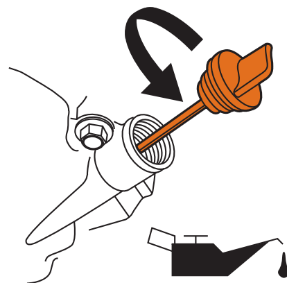
Figure 29 — Remplir l'huile de moteur
