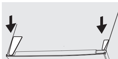
Fije la bisagra superior y su cubierta
