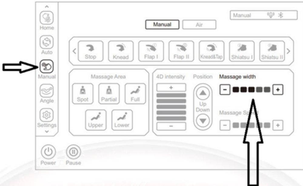
La largeur peut être ajustée uniquement lorsque l'utilisateur entre en mode manuel (**Manual**) en sélectionnant la technique de massage ou la zone de massage. La largeur de massage est réglable, le niveau 1 étant le plus étroit et 5 étant le plus large pour les techniques de massage suivantes : tapotement I (**Tap I**), tapotement II (**Tap II**), pression des doigts I (**Finger pressing I**), pression des doigts II (**Finger pressing II**), 4D III et 4D IV.
