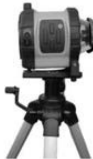
Una el instrumento al trípode utilizando el tornillo de 5/8" - 11
