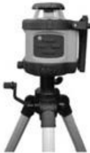
Una el instrumento al trípode utilizando el tornillo de 5/8" - 11
