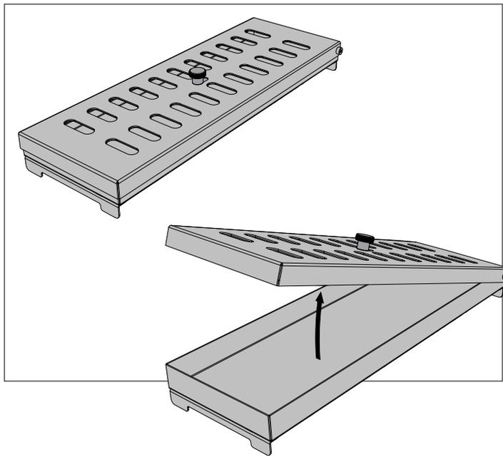
**i** Il est possible de régler les événements pour la fumée en faisant glisser le bouton pour contrôler l'intensité de la fumée.
