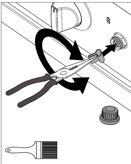
Le nettoyage du compartiment à piles est indispensable lorsque la batterie ne fonctionne pas correctement ou que l'on constate que des produits chimiques s'échappent. Maintenez toujours tous les boutons du brûleur et les robinets de la source de combustible en position OFF avant de commencer le processus de nettoyage du compartiment à piles.
