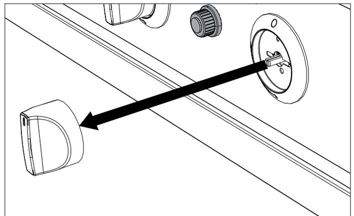
**3** Insérez un petit tournevis plat dans le trou prévu sur le panneau de commande.
