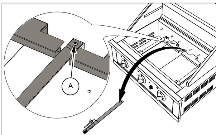
**2** Desserrez la vis de la vanne d'obturation d'air et tournez la vanne d'obturation d'air pour changer l'ouverture de l'air.
