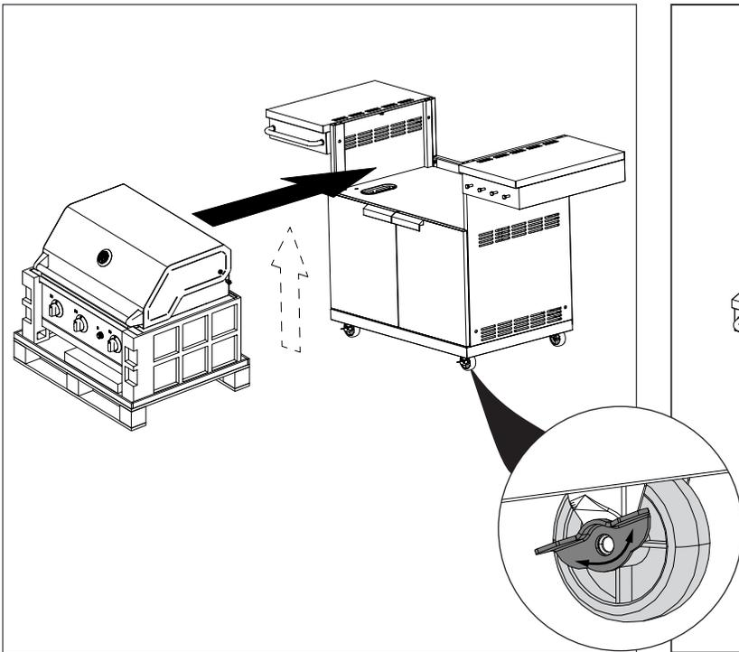
**REMARQUE :** Lorsque vous êtes prêt à installer l'appareil, placez-le directement sur l'armoire/chariot.
