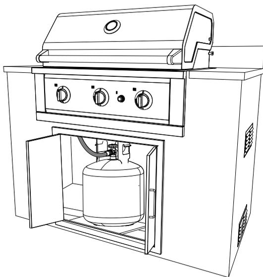
Le réservoir de propane doit être fixé au meuble encastré à l'intérieur de l'enceinte.
