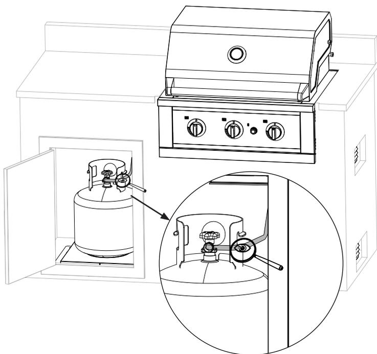
LE TUYAU DOIT AVOIR UN TRAJET EN SERPENT RÉGULIER POUR ÉVITER LES PLIS ET LES DÉFAILLANCES PRÉMATURÉES. VEUILLEZ EXAMINER LES TUYAUX ET LES RACCORDS POUR DÉTECTER LES FISSURES, LES DÉCHIRURES OU LES MARQUES D'USURE DUES AU FROTTEMENT, ETC.
