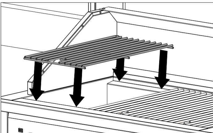
**5** Installez la grille réchauffage en la plaçant sur les supports fournis.
