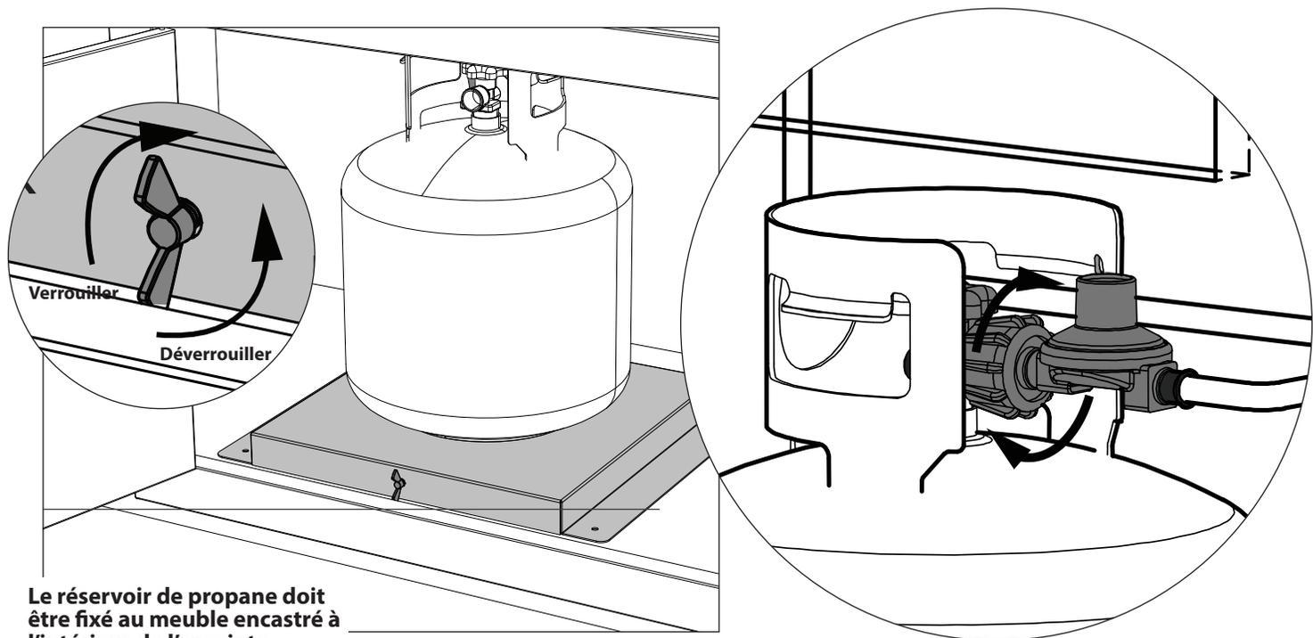
Le réservoir de propane doit être fixé au meuble encastré à l'intérieur de l'enceinte.
