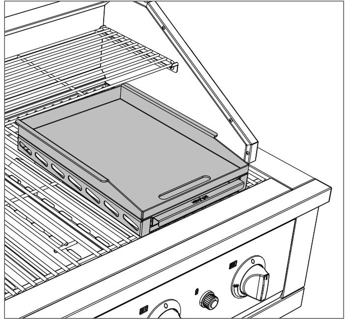
**i** Le bac à graisse peut être glissé à l'intérieur ou à l'extérieur de la plancha pour enlever la graisse collectée.
