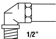
Il est recommandé de contrôler que l'appareil est adapté au type de gaz distribué. Le branchement au tuyau du gaz doit être effectuée dans les règles de l'art, conformément aux normes en vigueur qui prescrivent l'installation d'un robinet de sécurité situé à l'extrémité du tuyau. Le tuyau de branchement au gaz ½" fileté est situé à l'arrière de l'appareil à droite.
