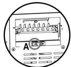
Cet appareil **est équipé** en usine d'un cordon d'alimentation électrique de type 4 fils avec cosses à bride de  $\frac{1}{4}$ " (L1, L2, N, Terre) adapté à une utilisation sur la cuisinière, type SRDT 2x6AWG + 2x8AWG homologué UL/CSA pour 125/250 VAC, 50A avec une prise enfichable type NEMA 14-50P; longueur de câble 4'.
