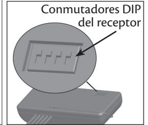
4-1. **¡IMPORTANTE!** Antes que cambie los ajustes de los conmutadores DIP, asegúrese que la batería no esté conectada al transmisor.
