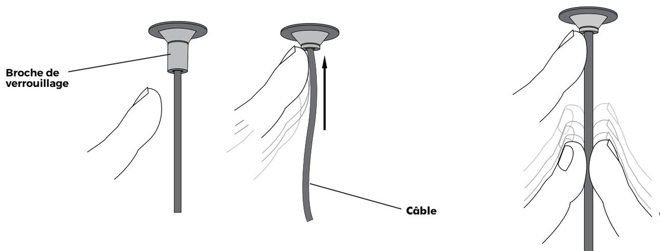
La longueur du câble est réglable. Pour régler le câble à la longueur souhaitée pour le luminaire, maintenez la coupole du luminaire contre le boîtier de prise électrique dans le plafond.
