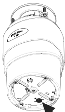
Position des Reset-Schalters
