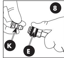
**⚠ ADVERTENCIA: Los objetos despedidos podrían causar lesiones graves. Asegúrese de que la boquilla esté completamente insertada en el adaptador de conexión rápida y que el anillo a presión de conexión rápida esté totalmente trabado (hacia adelante) antes de oprimir el disparador de la pistola.**
