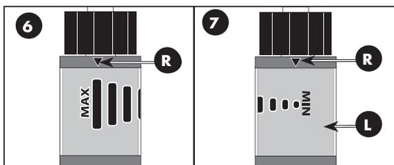
Réglez la pression en faisant tourner le régulateur de pression réglable (L) dans le sens des aiguilles d'une montre pour augmenter la pression ou dans le sens contraire pour diminuer la pression, en alignant la flèche avec la ligne indiquant la pression désirée du régulateur de pression réglable.
