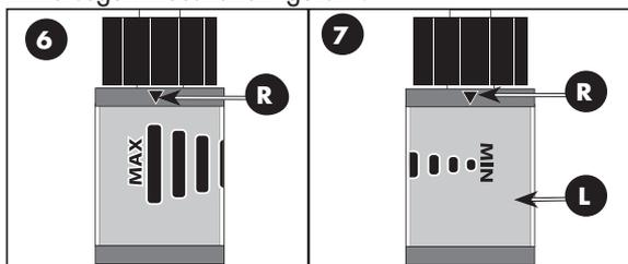
Ajuste la presión girando regulador de presión ajustable (L) en sentido horario para subir la presión o en sentido antihorario para bajar la presión, alineando la flecha con la barra de presión deseada en regulador de presión ajustable.
