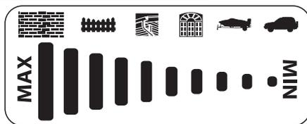
**NOTA:** Para aplicar productos químicos instale la boquilla negra de baja presión y gire el regulador de presión ajustable a la posición de MAX.
