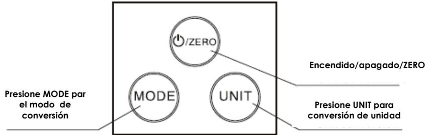
1. El botón On/Off-Zero es para encender o apagar el aparato y restablecer la balanza a 0.00 (función de tara).
