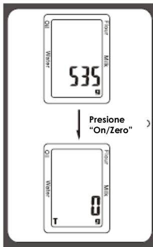
La función de tara es de gran utilidad para calcular el peso de los ingredientes que no se pueden poner directamente en la plataforma. Por ejemplo la harina, o líquidos, que requieren un recipiente antes de pesarlos, o para el peso de ingredientes que se añaden tras el primer peso, sin tener que quitar el producto inicial
