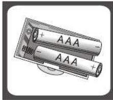
Cet appareil fonctionne avec 2 piles de 1.5V, de type AAA (non fournies). Pour installer les batteries, ouvrez le couvercle du logement des piles situé au-dessous de la balance. Introduisez les piles en respectant les polarités indiquées dans le compartiment, puis refermez le couvercle. Vous pouvez maintenant utiliser votre balance.
