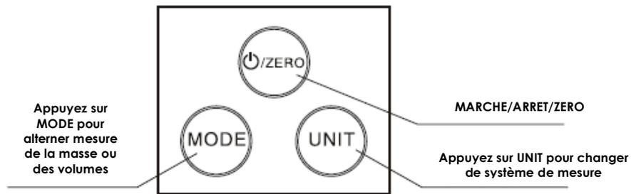
1. Le bouton ON/ZERO est utilisé pour allumer ou éteindre la balance, et pour la réinitialiser (Fonction TARE).
