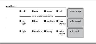
Après avoir sélectionné un programme, les réglages par défaut correspondant à ce programme s'allument. Appuyer sur les boutons de modificateurs du programme pour changer la Wash Temp (Température de lavage), la Spin Speed (Vitesse d'essorage) et le Soil Level (Niveau de saleté) si désiré. Tous les réglages ne sont pas disponibles avec tous les programmes.
