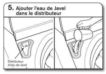
Ne pas remplir excessivement le distributeur, diluer le produit ni utiliser plus de 3/4 de tasse (180 mL). Afin d'éliminer le maximum de saleté et de taches, utiliser le distributeur d'eau de Javel pour de l'eau de Javel, ou l'agent de blanchiment sans danger pour les couleurs.
