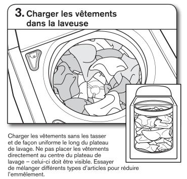
**IMPORTANT**: Les articles doivent pouvoir se déplacer librement pour un nettoyage optimal et pour réduire le froissement et l'emmêlement.
