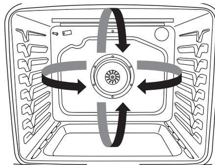
Durant la cuisson ou le rôtissage par convection, les éléments de cuisson au four, cuisson au grill et de convection s'allument et s'éteignent par intermittence tandis que le ventilateur fait circuler l'air chaud. Durant la cuisson au grill par convection, les éléments de cuisson au grill et de convection s'allument et s'éteignent par intermittence.
