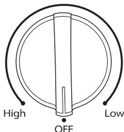
Les boutons de commande peuvent être réglés sur n'importe quelle position entre HIGH (élevé) et LOW (bas). Pousser et tourner le bouton jusqu'au réglage choisi.
