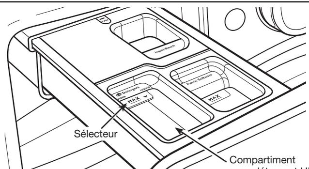
Verser une mesure de détergent HE dans le compartiment à détergent. Pour du détergent en poudre, soulever le sélecteur en position élevée. Pour du détergent liquide, appuyer sur le sélecteur pour le placer en position basse.
