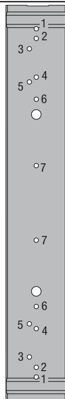
PATRÓN DE AGUJEROS DE LARGUERO DEL EXTREMO (LADO IZQUIERDO. EL LADO DERECHO ES EL LADO OPUESTO.)
